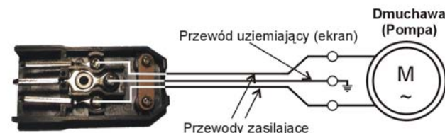
Rys. Podłączenie przewodów od dmuchawy/pompy do wtyczki.
